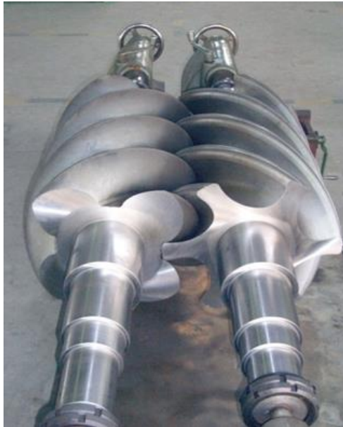
Figura 2: Par de parafusos helicoidais. (3)
